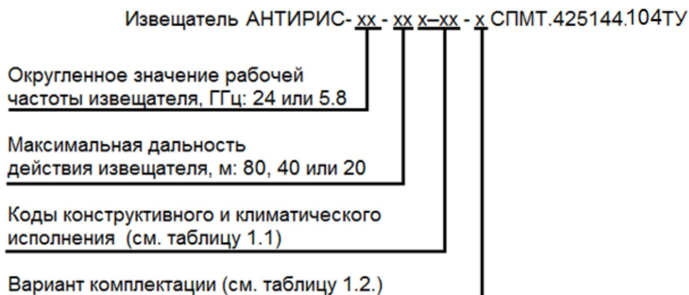
Ниже в качестве примера приведено обозначение извещателя АНТИРИС с рабочей частотой 5,8 ГГц, максимальной дальностью действия 20 м в «индустриальном арктическом» исполнении, укомплектованный КМЧ-5:
