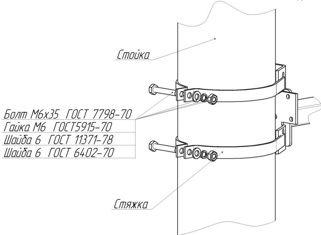
Рисунок 7 – Крепление блоков ПРМ и ПРД с помощью стяжек
