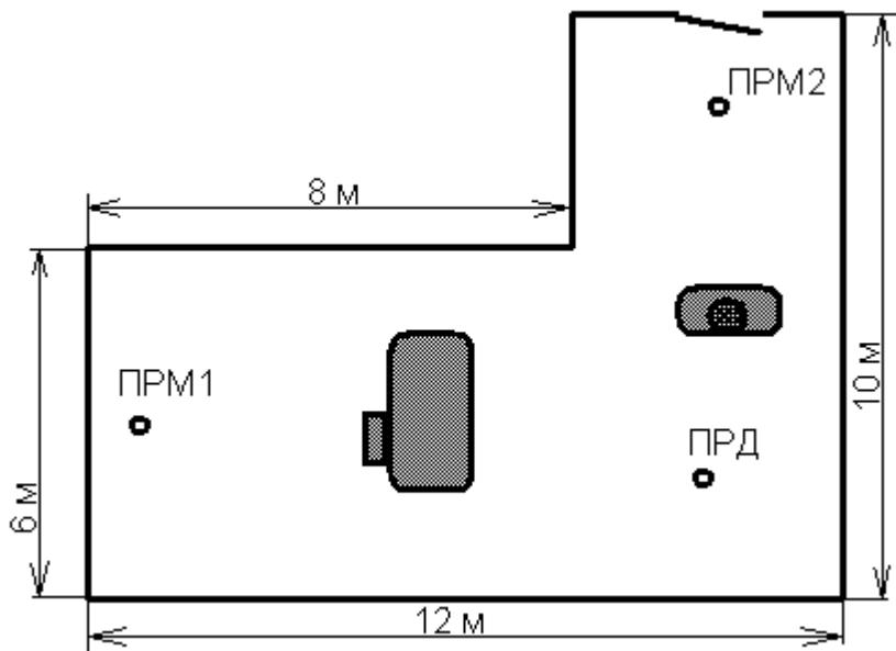
Рисунок В.2 – Размещение извещателя на площадке сложной формы с использованием дополнительного ПРМ
