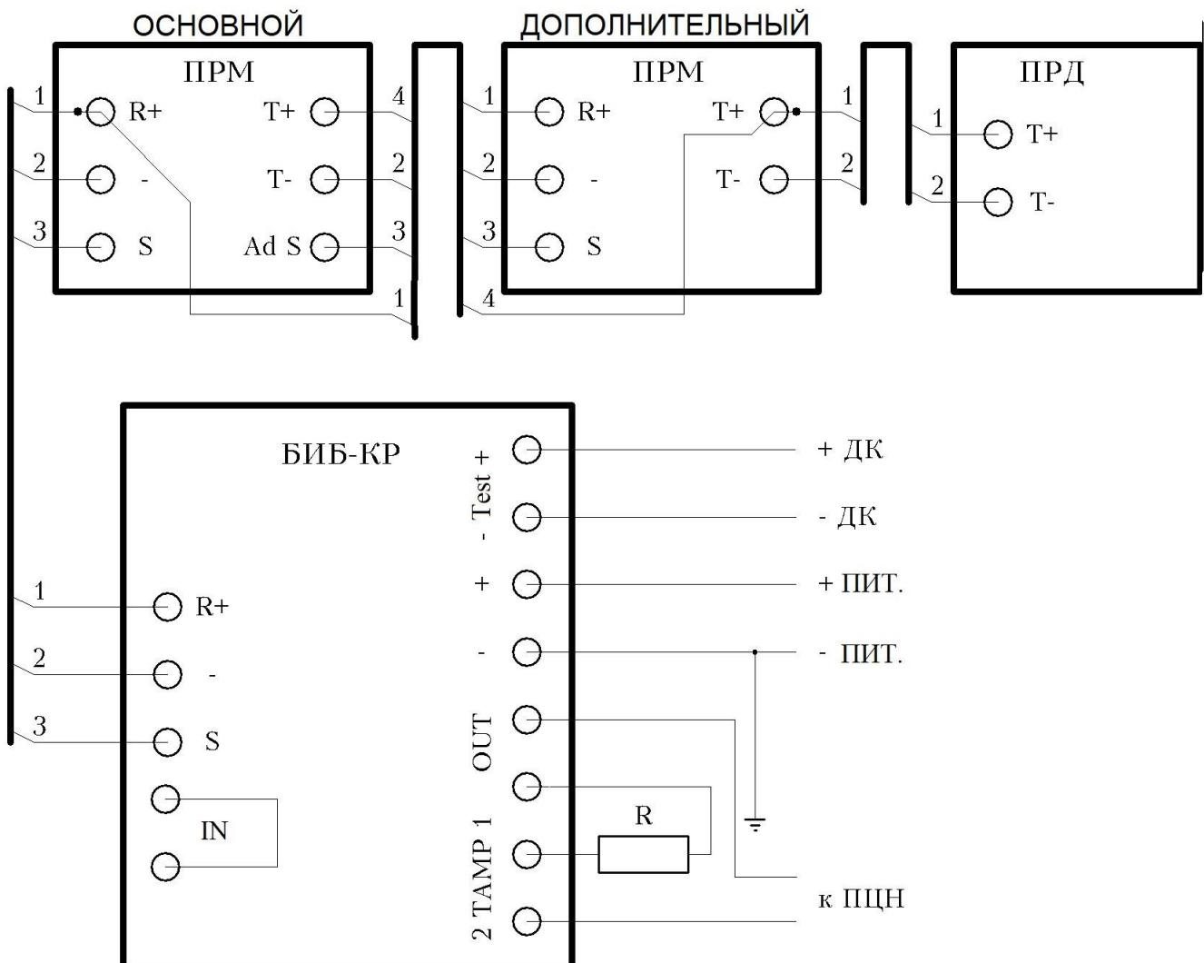
Рисунок Б-2 – Схема подключения извещателя с использованием дополнительного ПРМ
