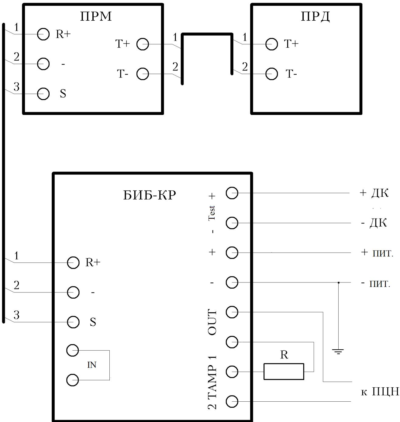
Рисунок Б-1 – Схема подключения извещателя
