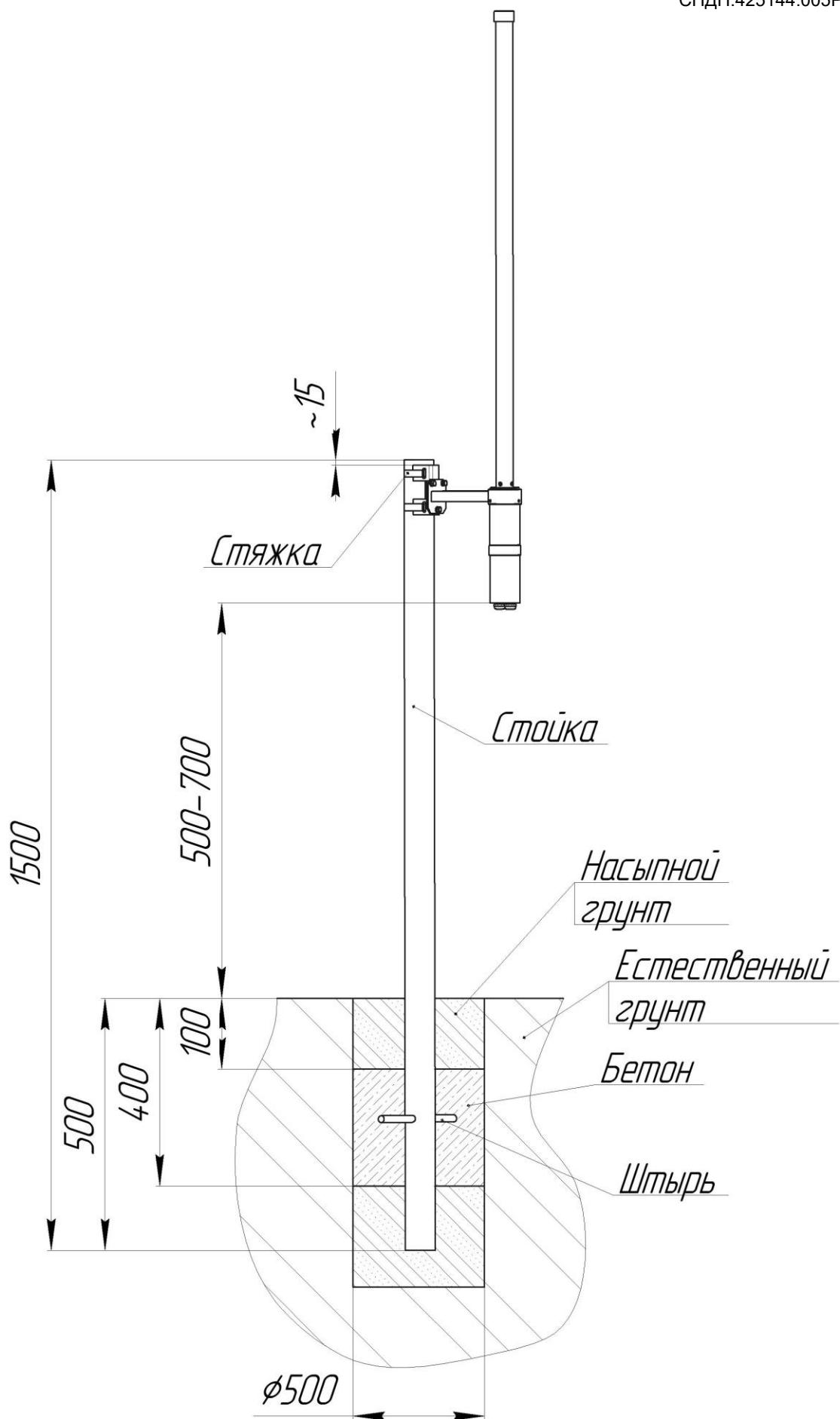
Рисунок 6 – Установка извещателя с использованием КМЧ-С
