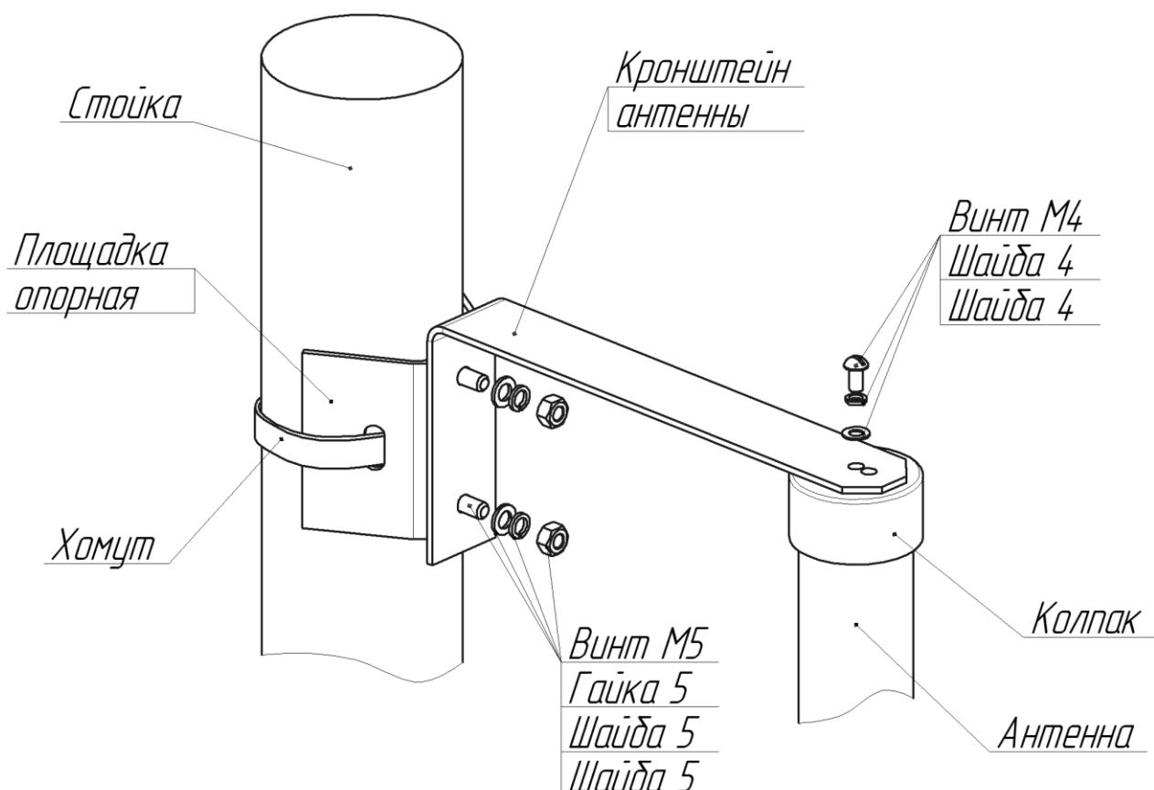
Рисунок 5 – Крепление антенны на опоре
