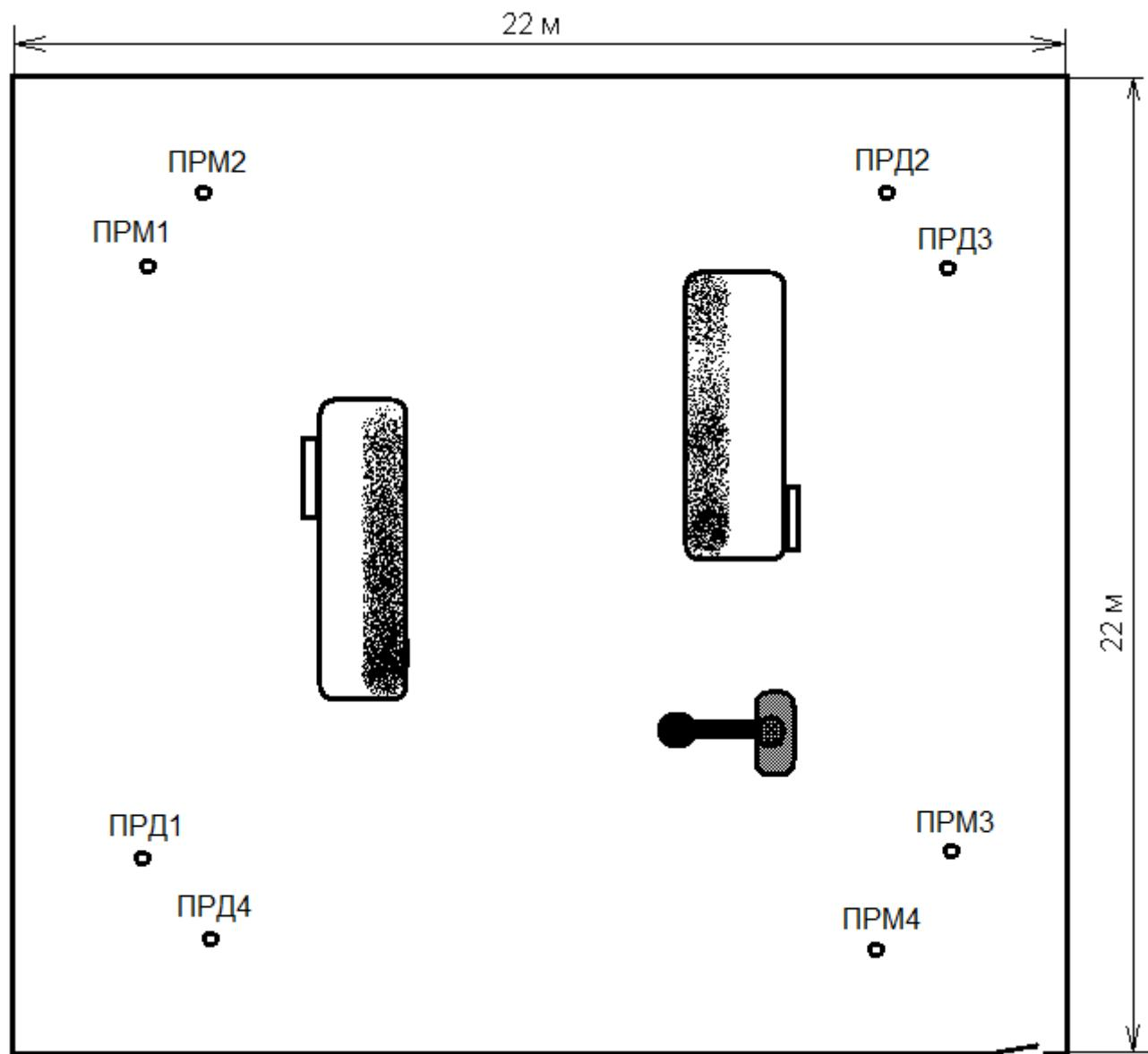
Рисунок В.3 – Размещение четырех извещателей на площадке больших размеров
