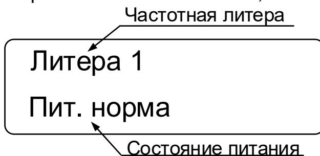
Рисунок Б.1 – Индикация состояния блока ПРД
