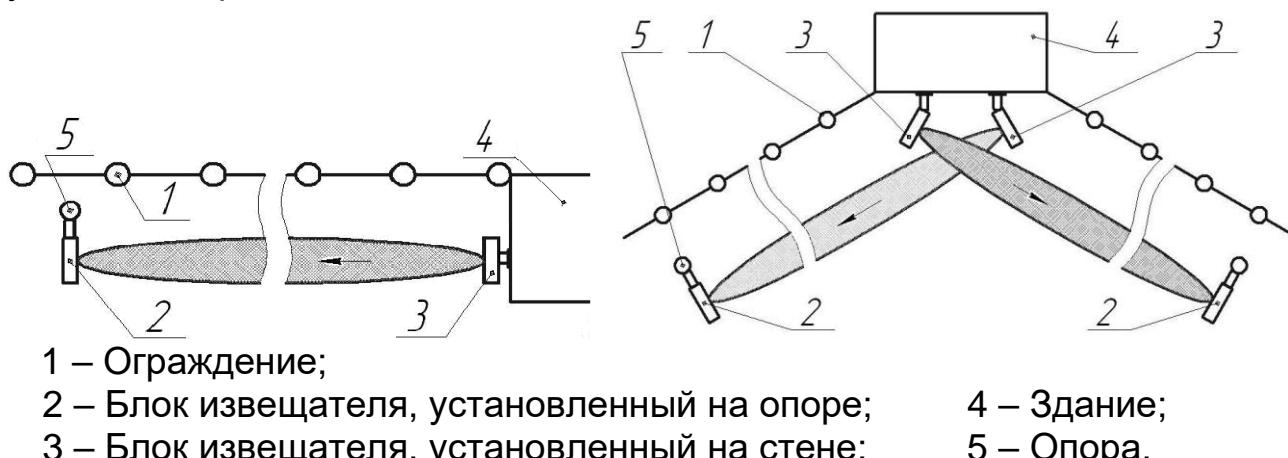
Рисунок 2.2 – Примеры установки блоков на стенах зданий
