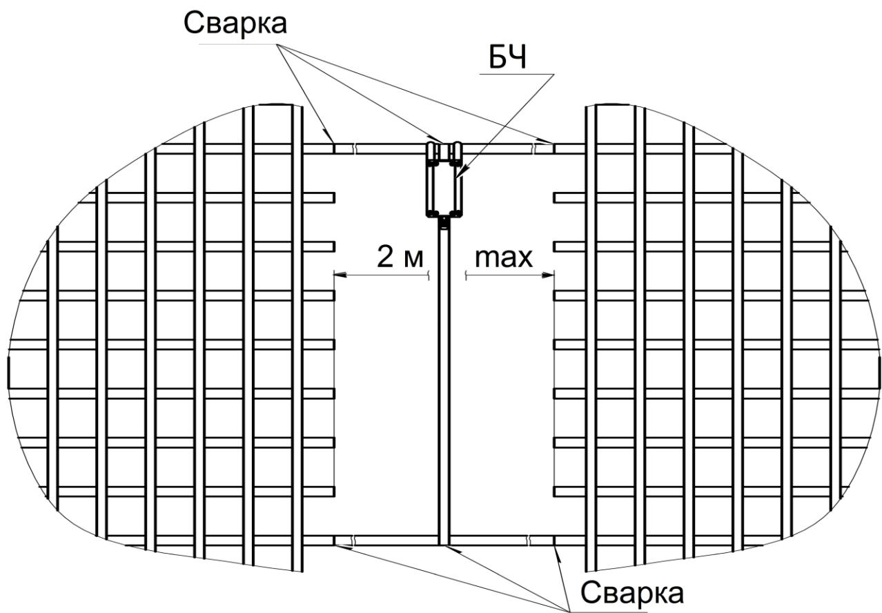
Рисунок 3 – Крепление БЧ на соединителе решеток
