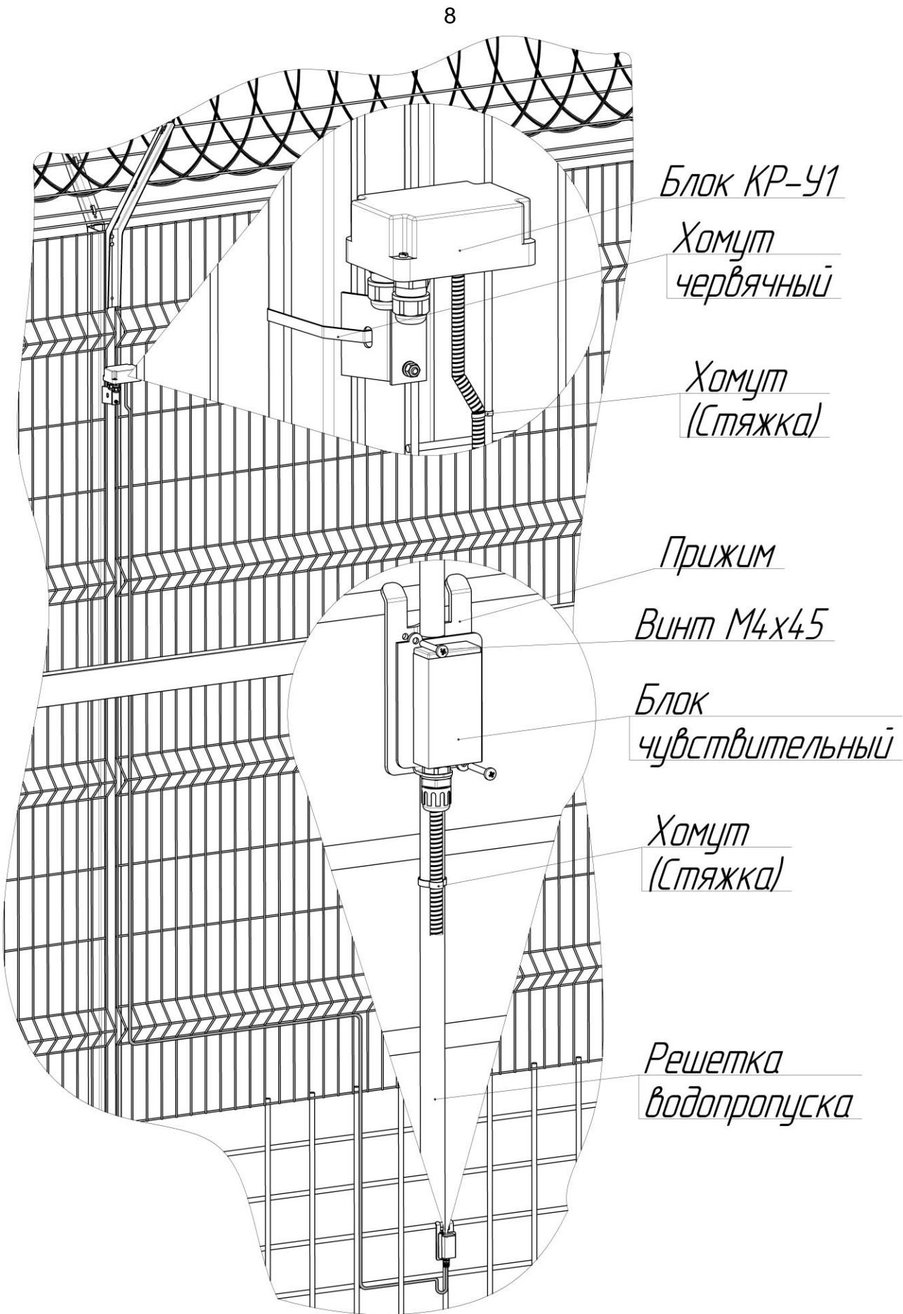
Рисунок 2 – Крепление извещателя на решетке водопропуска
