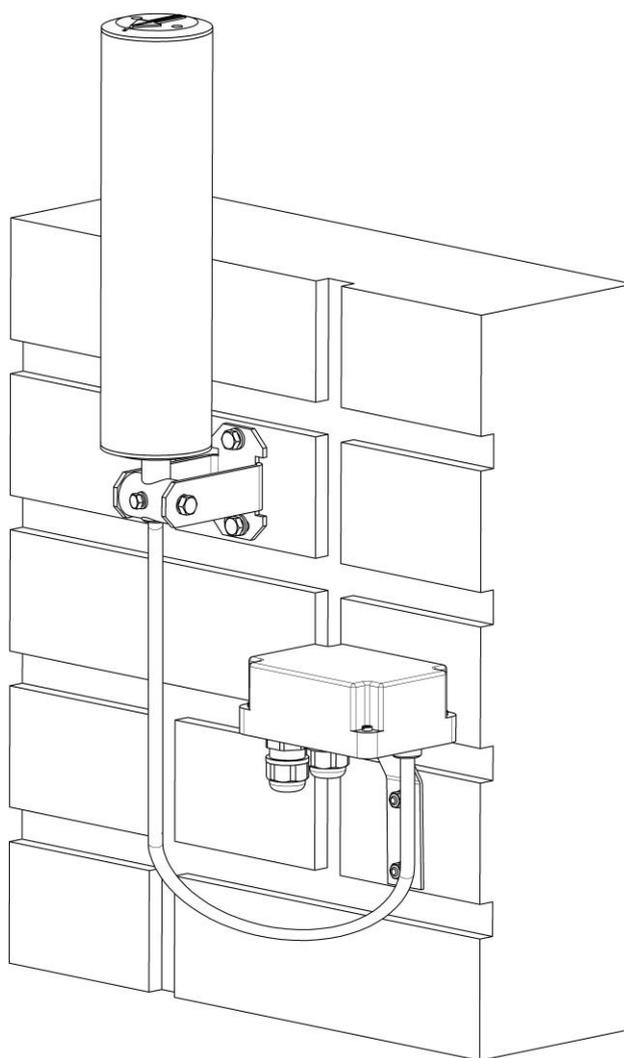
Рисунок 1.5 – Способ крепления приемопередатчика на плоской поверхности
