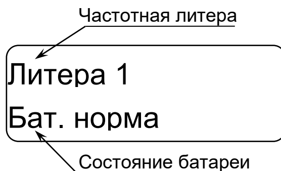
Рисунок Б.3 – Окно состояния ПРД
