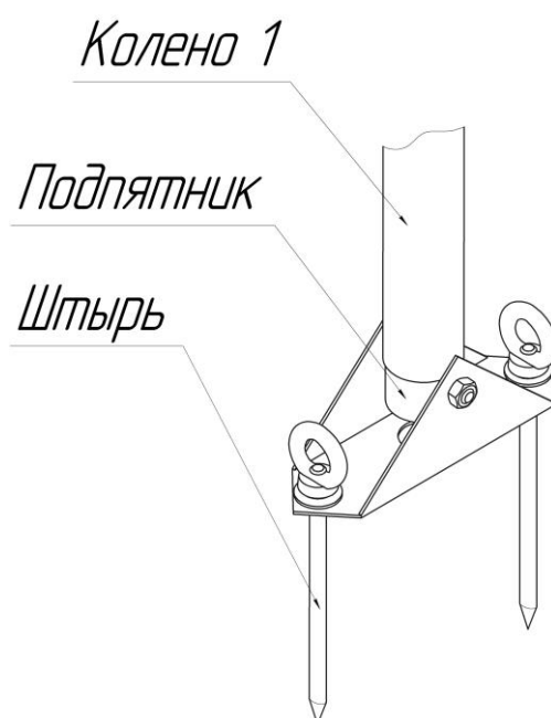
Рисунок 1.23 – Соединение подпятника с коленом
