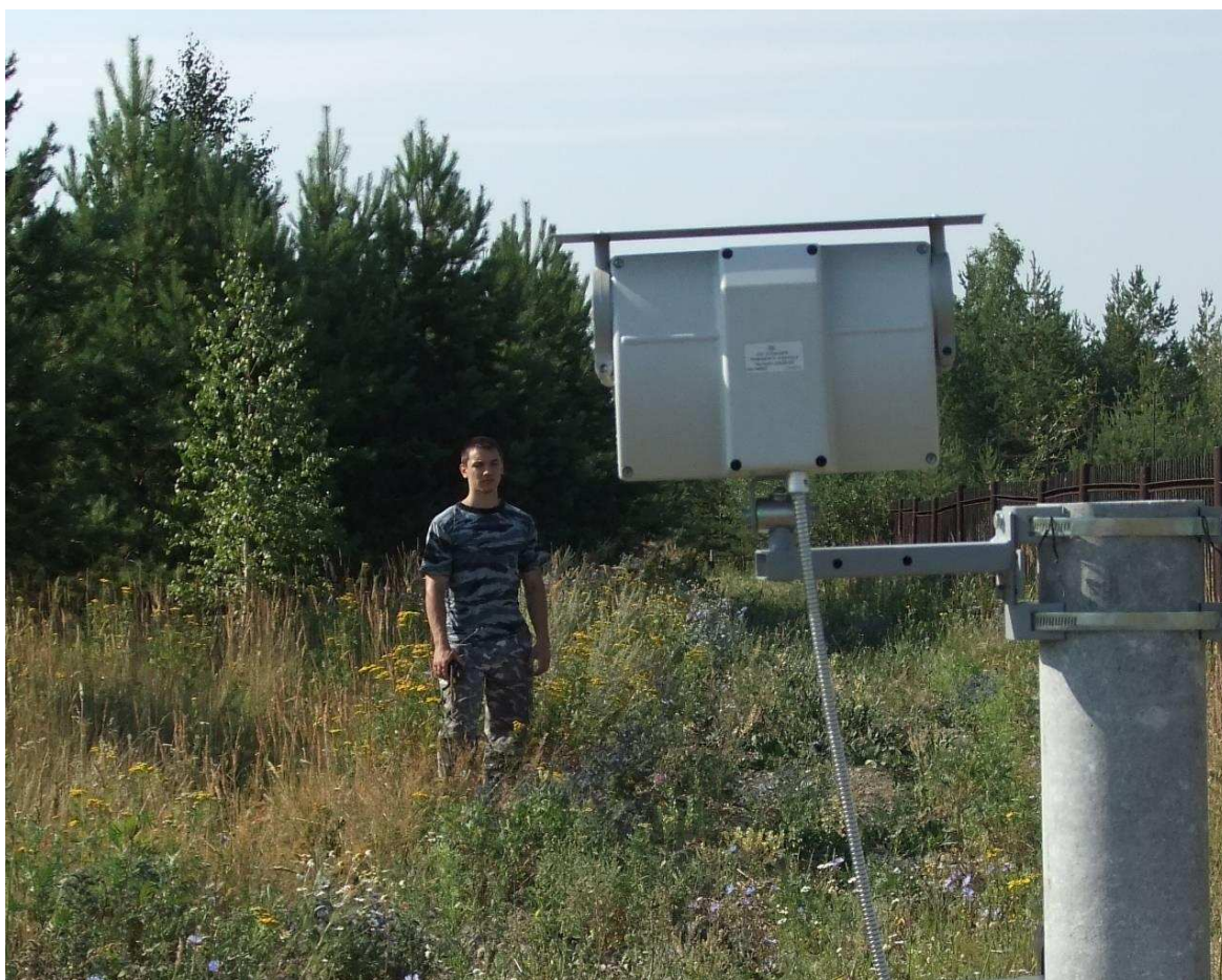
Рисунок 3 – Антирис-5.8-20 окончание испытаний (предельный уровень травы для АНТИРИС-5.8-20)
