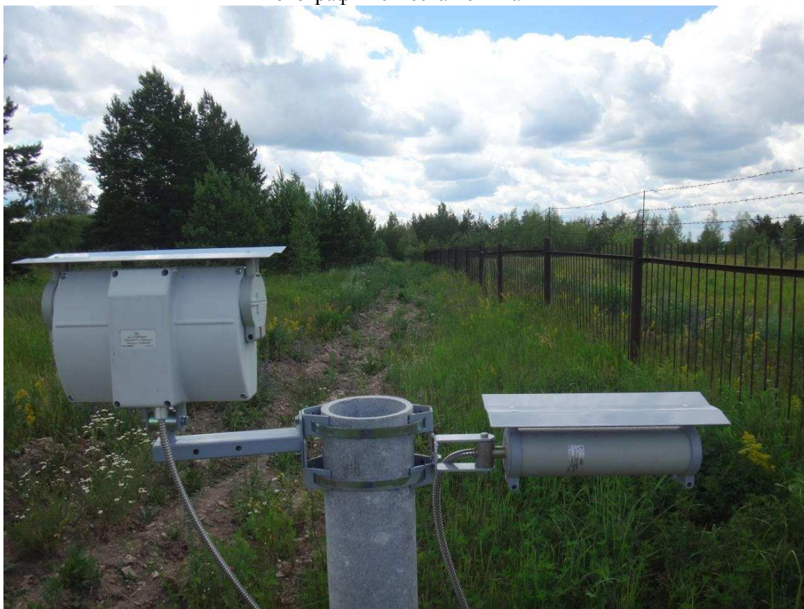
Рисунок 2 – АНТИРИС-5.8-20 и АНЧАР-40, совместная работа на одном участке (предельный уровень травы для извещателя АНЧАР-40)
