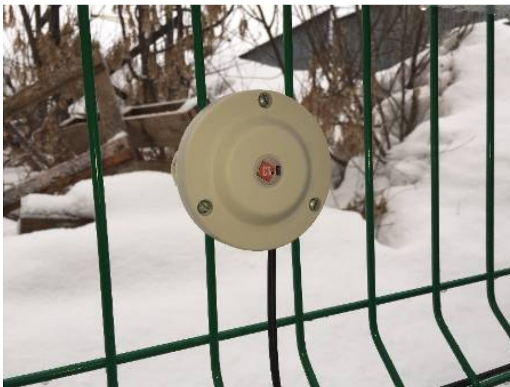
Рисунок 2 – Крепление ДВ на ограждении типа «Махаон-Стандарт»
