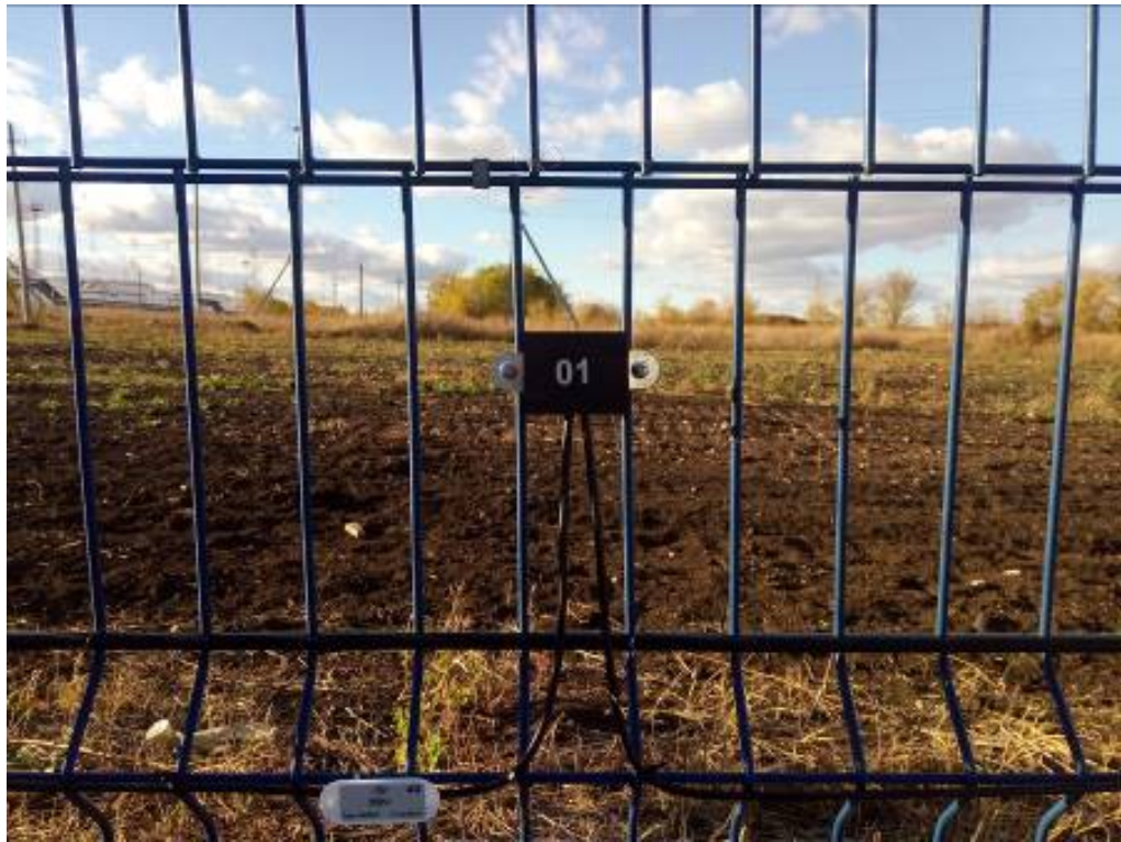
Рисунок 3 – Крепление ДВ-ЛВЧ на заграждении типа «Махаон-Стандарт»
