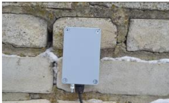
Рисунок 20 – Установка ДВ на кирпичном ЗГР
