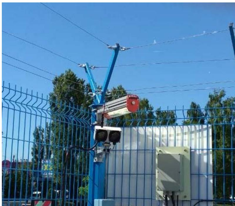
Рисунок 5 – Крепление МВР-Р на заграждении типа «Махаон-Стандарт»
