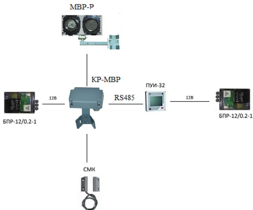
Рисунок 3 – Подключение выходной цепи извещателя к MBP-RS485
