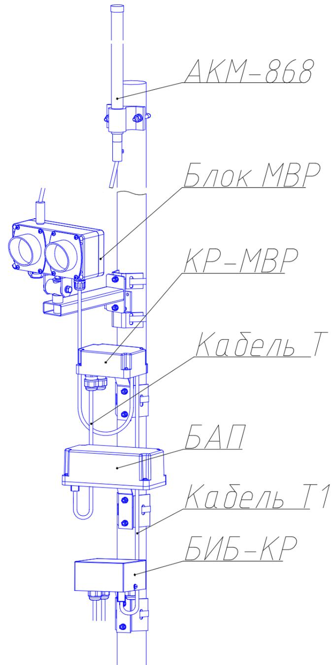
Чертеж установки МВР-RS485 на опоре
