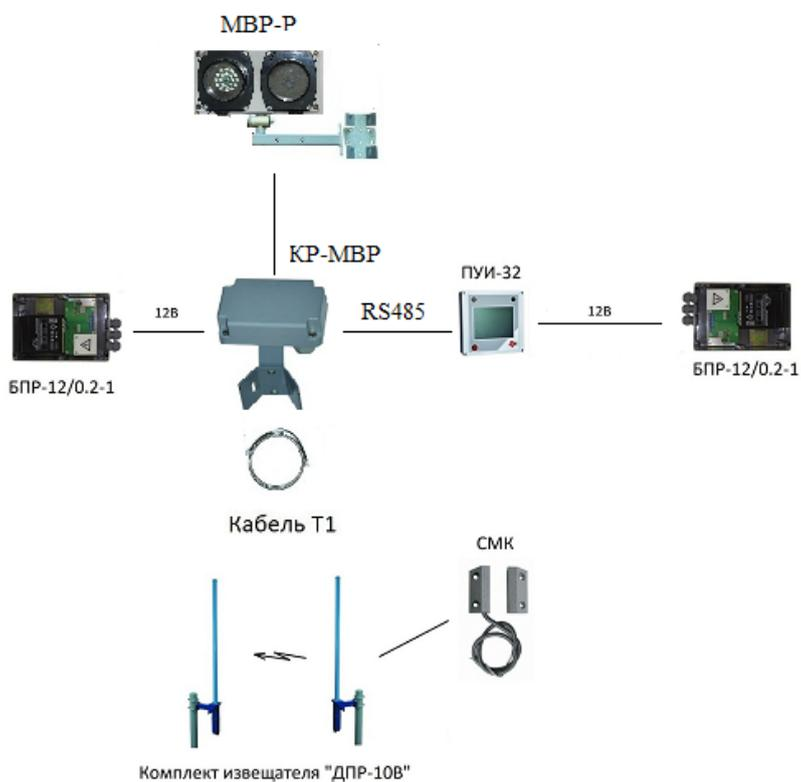
Рисунок 4 – Подключение ДПР-10В к MBP-RS485
