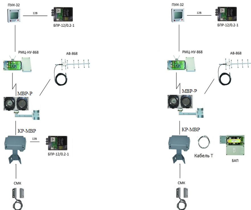
Рисунок 2 – Варианты подключения выходной цепи извещателя к МВР-Р
