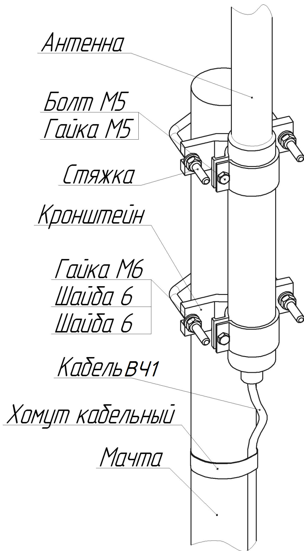
Рисунок 1 – Установка Комплекта Антенны АКБ-433 на мачте
