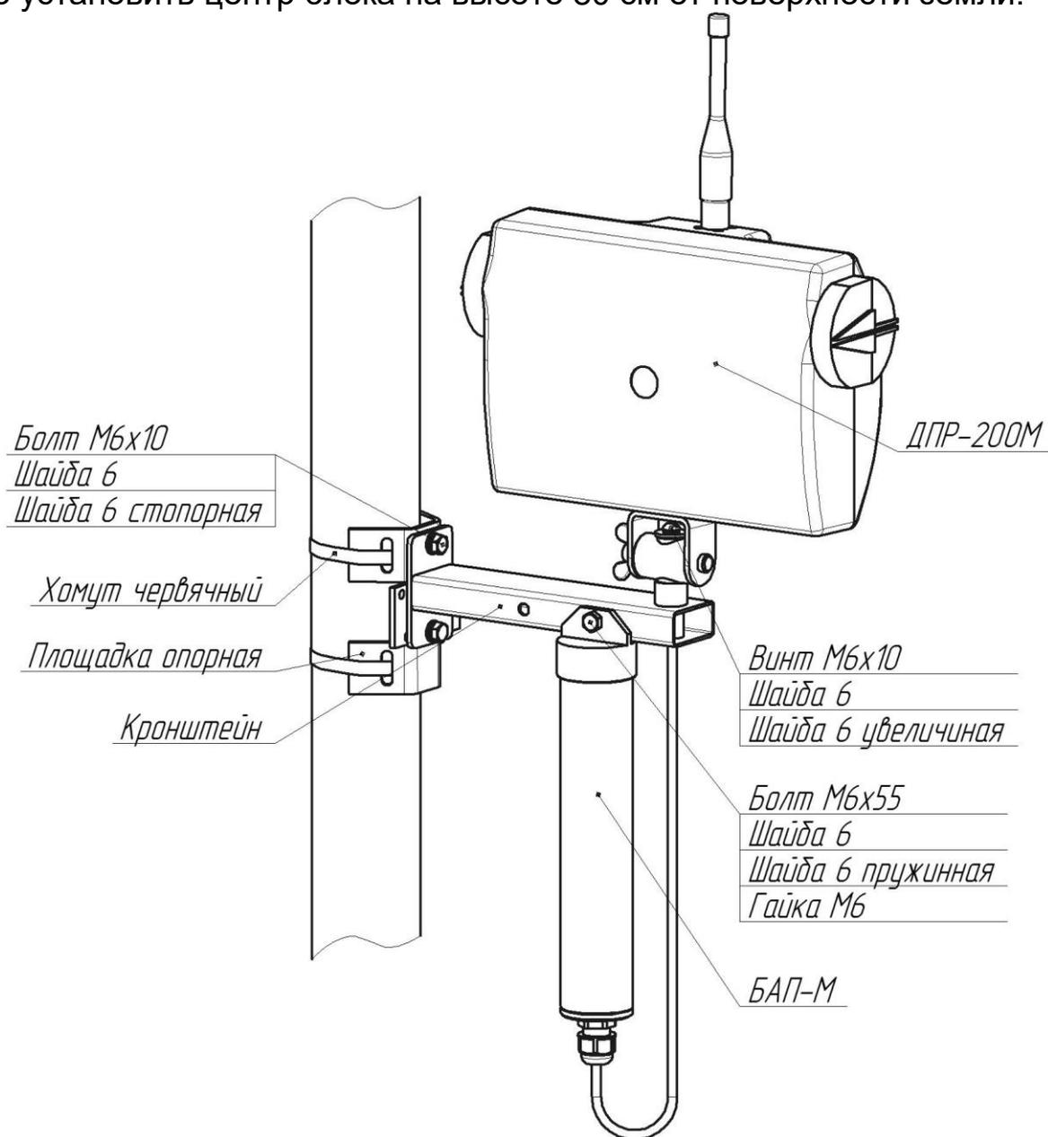
Рисунок 1 - Крепление блока ПРМ (ПРД) на стойке
