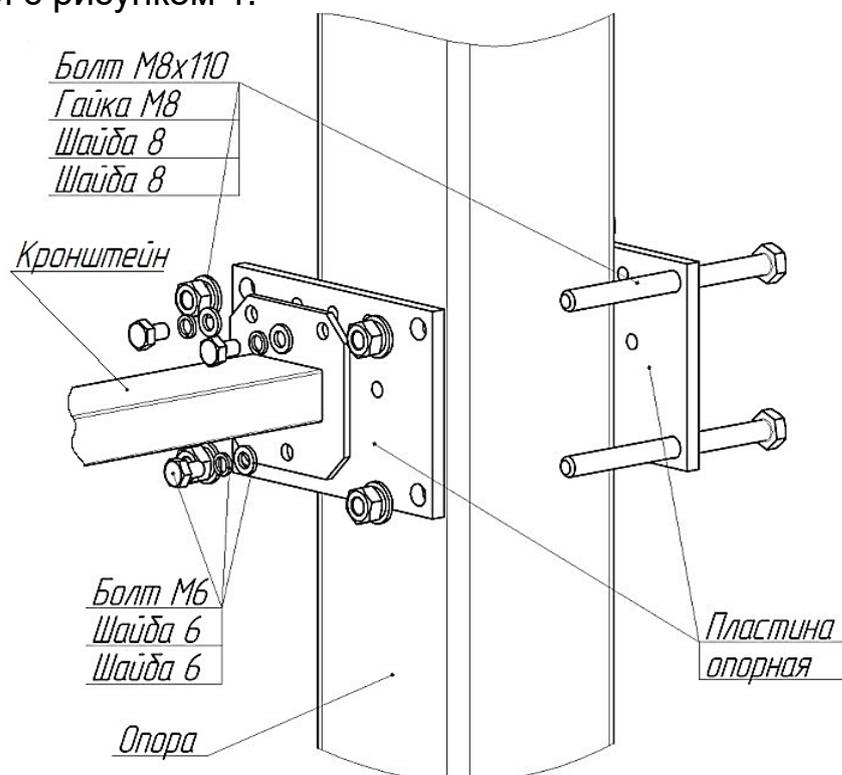
Рисунок 1 – Крепление блоков (кронштейнов) извещателей на опоре
