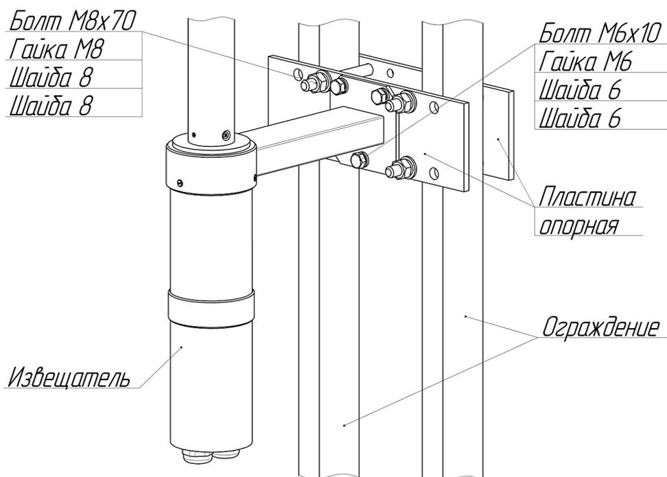
Рисунок 2 – Крепление блоков извещателя ДПР-10В на полотно ограждения
