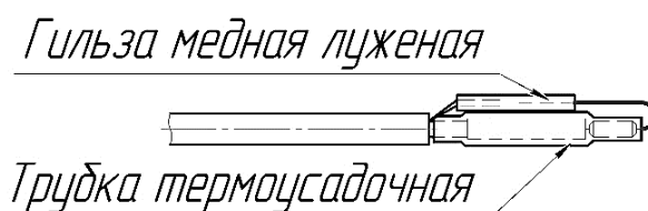
Рисунок 4 – Установка гильзы медной луженой на жилы экрана и резистор
