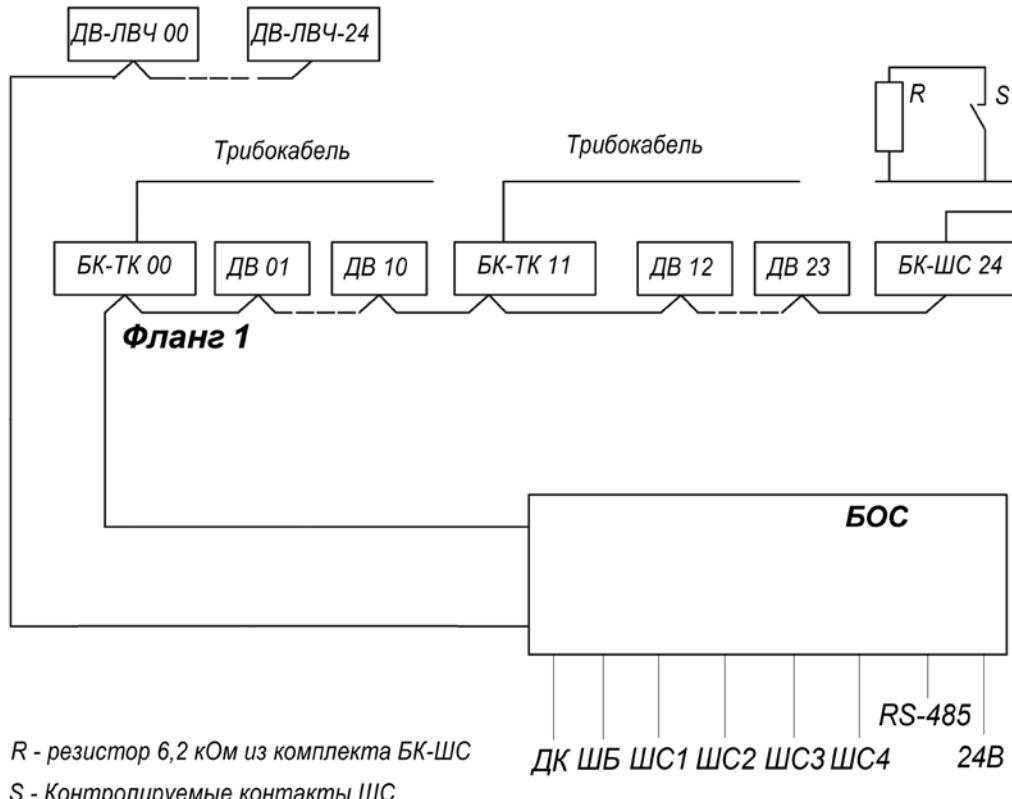
Рисунок 1.1а - Структурная схема извещателя с использованием БОС
