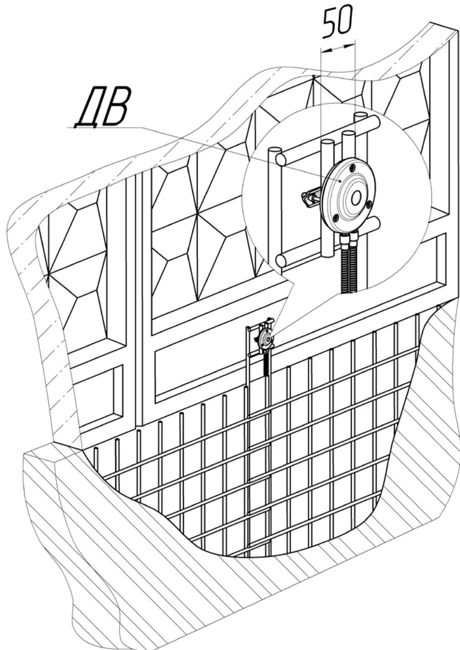
Рисунок 2.4 – Установка ДВ на решетку водопропуска
