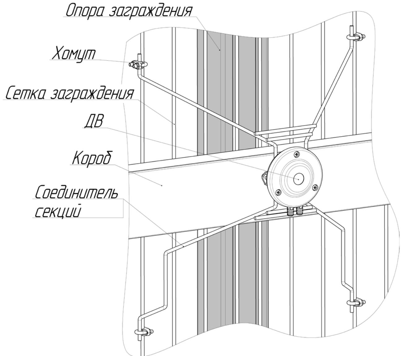
Рисунок 1.9 – Соединитель секций
