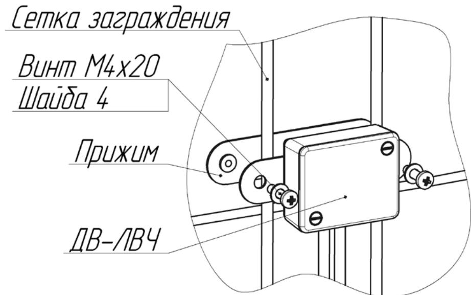
Рисунок 1.8 – Установка ДВ-ЛВЧ на заграждение
