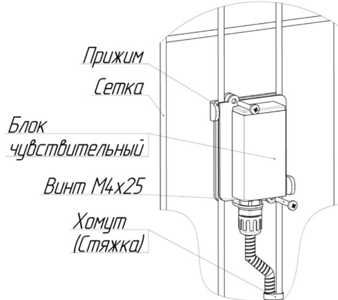
Рисунок 1.10 – Крепление БЧ на сетке
