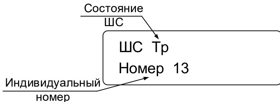
Рисунок В.8 – Окно индикации состояния БК-ШС
