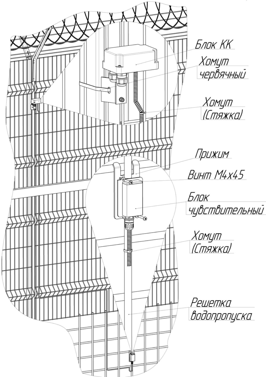
Рисунок 2.6 – Установка ДВ-Г на решетке водопропуска
