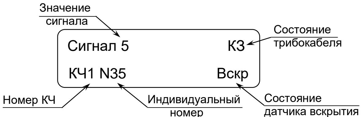
Рисунок В.6 – Окно индикации состояния БК-ТК (БК-ТК-2)
