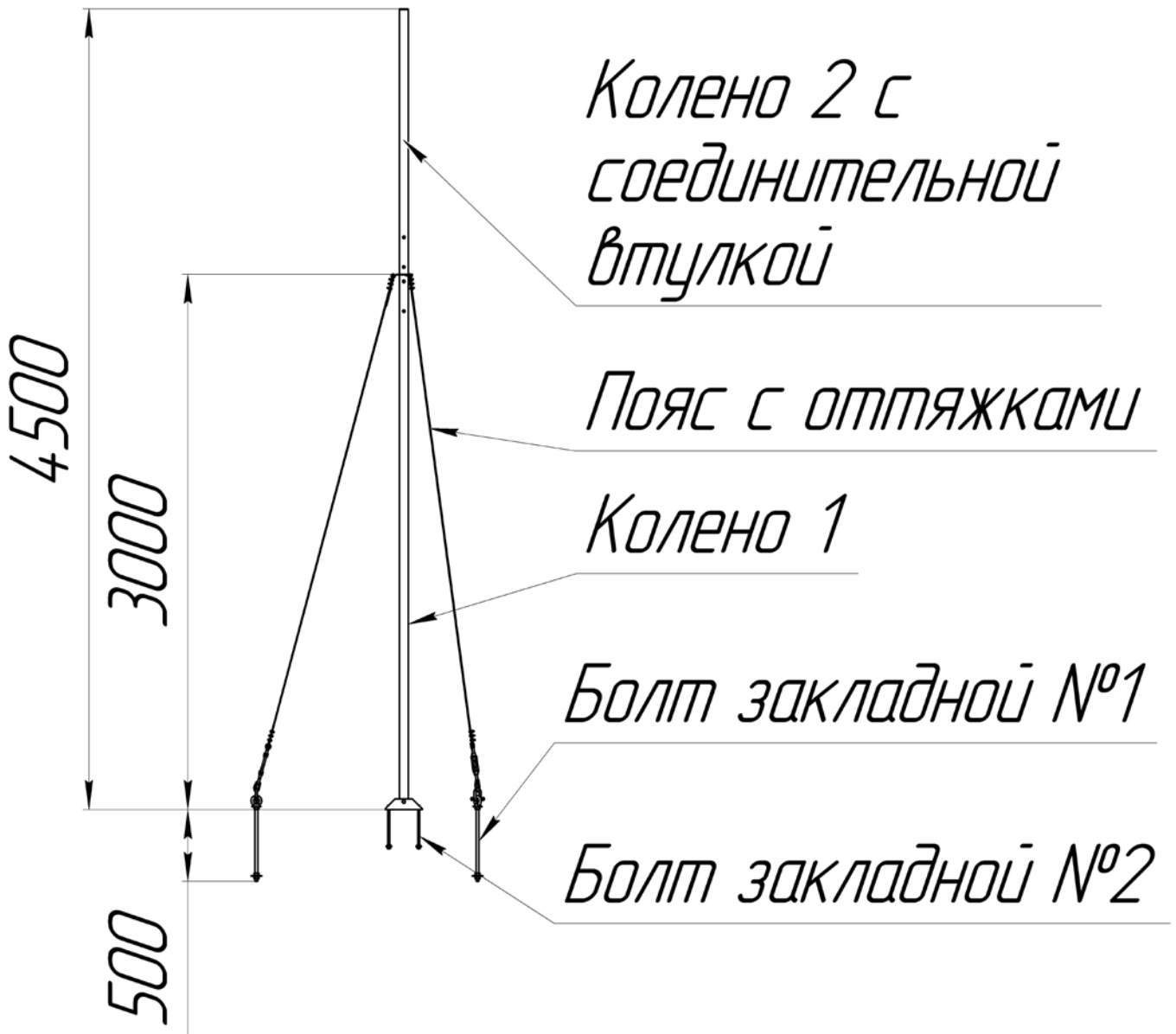
Рисунок 1 – Общая схема комплекта мачты ММ
