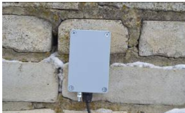
Рисунок 20 – Установка ДВ на кирпичном ЗГР
